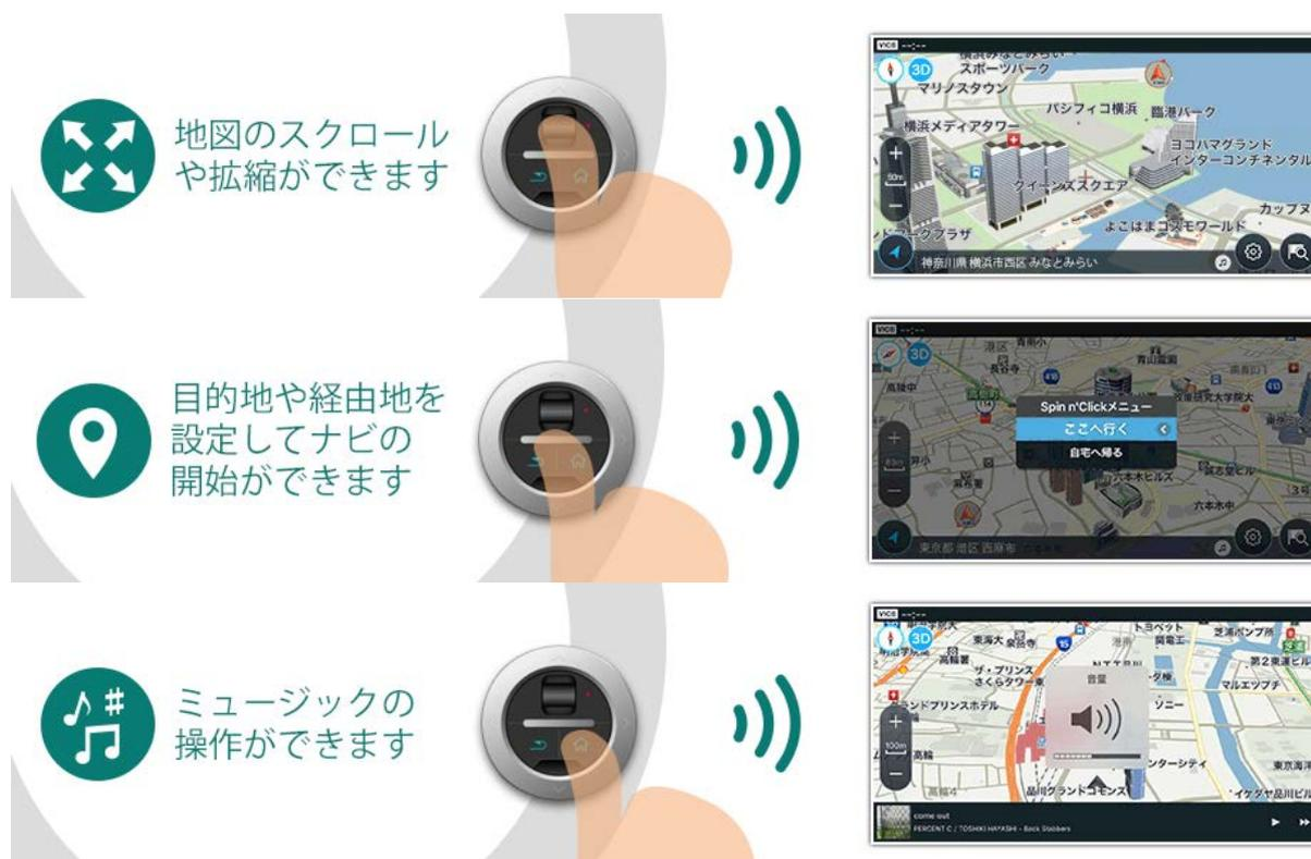
「くるくるピ」は人間工学を考慮したスイッチの大きさや配置を実現し、親指だけで操作が可能です。コントローラーの開発では、デンソーがこれまでに培ってきたBluetoothを活用した車載機の技術を応用し、株式会社Braveridgeへ技術協力し開発しています。
